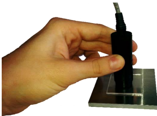
Рисунок 2.24 – Установка преобразователя на образец с покрытием
