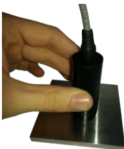
Рисунок 2.4 – Установка преобразователя на образец без покрытия
