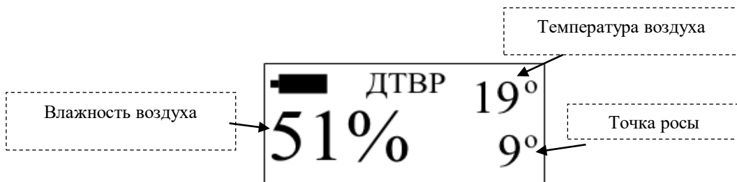
Рисунок 2.12 – Графический индикатор при измерении преобразователем ДТВР
