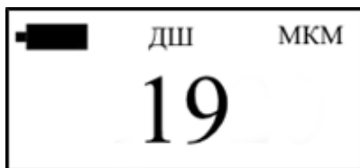
Рисунок 2.10 – Графический индикатор после измерения датчиком ДШ
