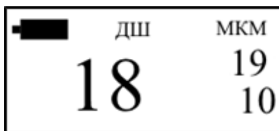
Рисунок 2.11 – Оценка шероховатости в режиме с усреднением
