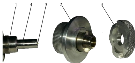
1 – корпус; 2 – съемная разборная насадка; 3 – съемная двухсторонняя упорная шайба; 4 – центровочная трубка; 5 – алмазный наконечник
