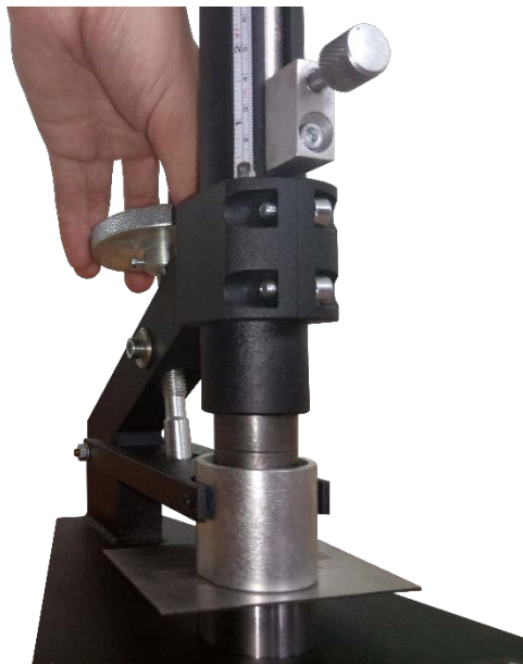
Рисунок 2.2 – Установка образца на наковальню
