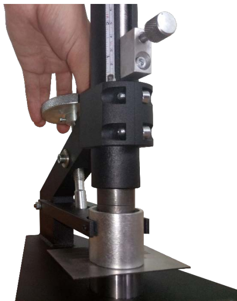
Рисунок 2.4 – Установка образца на наковальню
