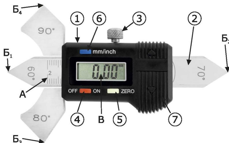
Рисунок 1 – Общий вид измерительного шаблона сварщика WG3 цифровой ЭЛИТЕСТ 1 – рамка; 2 – измерительный движок; 3 – стопорное устройство; 4 – кнопка вкл./выкл.; 5 – кнопка установки нуля; 6 – кнопка мм/дюйм; 7 – батарейный отсек; А – измерительная шкала; Б 1-4 – контрольные углы; В – дисплей
